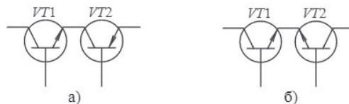
Рис. 5.5. Расчетная модель транзистора при последовательном включении управляющего транзистора и нагрузки
