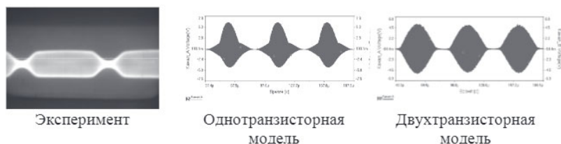
Рис. 5.31. Результаты экспериментальных и расчетных исследований формы сигнала на выходе устройства управления
